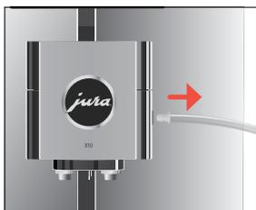
Если при вспенивании молока образуется слишком мало пены или если молоко разбрызгивается из комбинированного дозатора, то он может быть загрязнен. В этом случае разберите и промойте комбинированный дозатор.
